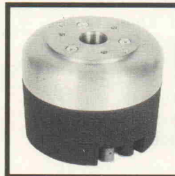
DR 11.13. Professioneller Mittelhochton-Treiber. Sehr ausgeglichener Frequenzgang. 70/100 W, 8 Ohm. Übertragungsbereich 800—20 000 Hz (1 000—12 000 Hz \pm 2 dB), mittl. Kennschalldruck 108 dB/1W/1m.
